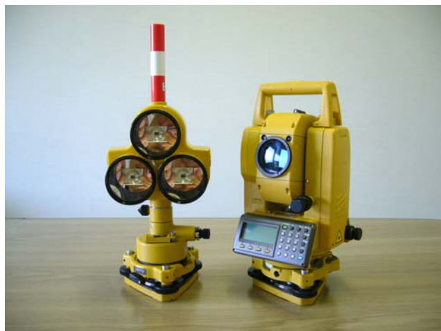
左：反射鏡 3 プリズム 右：光波測距儀 (3 素子)
